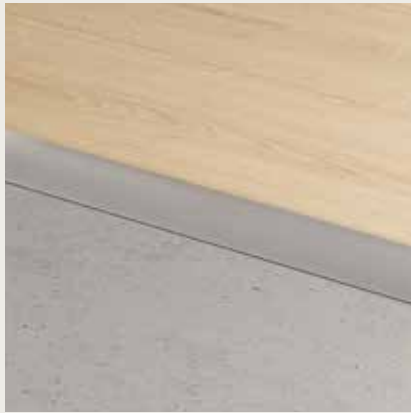
PERFIL DE ADAPTACIÓN 2000 × 38 × 7 mm Para cubrir la junta de dilatación entre un suelo superior y uno inferior. Superficie: aluminio. SFADPSILV | SFADPCOFF | SFADPCLAY | SFADPCHAM | SFADPBLACK
