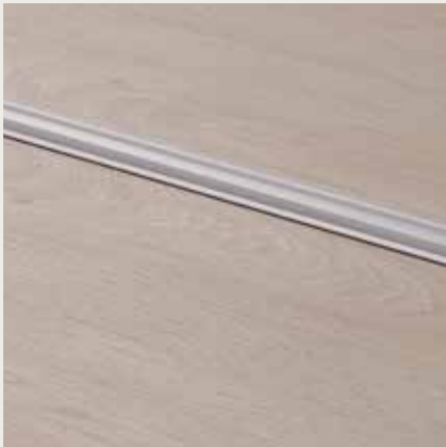
PERFIL MULTIUSO, PLATA 1860 × 47 × 16 mm Perfil y adaptador de dilatación todo en uno. Adecuado para diferencias de altura de entre 0 y 12,3 mm. Peso: 10 mm (no instalado). Aluminio. PGPRSILV
