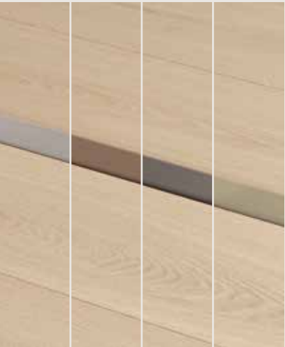
PERFIL DE DILATACIÓN 2000 x 34 x 7 mm Para cubrir la junta de dilatación entre dos suelos de la misma altura. Superficie: aluminio. Disponible en varios colores: plata, café, arcilla y champán.
