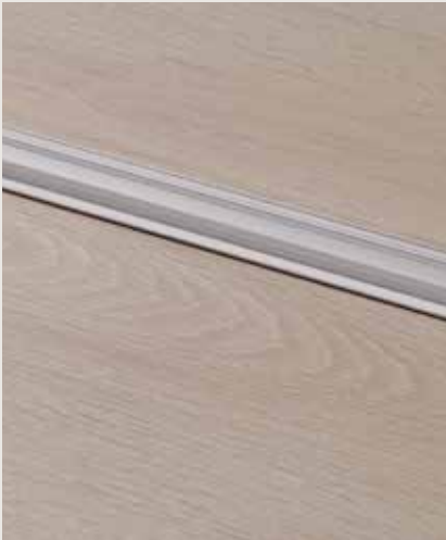
PERFIL MULTIFUNCIONAL PLATA 1860 x 47 x 16 mm El perfil multifuncional Pergo puede nivelar diferencias de altura para crear una transición suave a cualquier otro tipo de suelo. Adecuado para diferencias de altura de 0 a 12,3 mm. Superficie: aluminio. PGPRSILV
